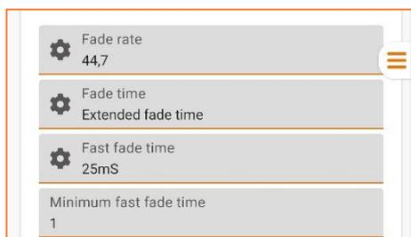
**Tasso di dissolvenza (Fade rate):** indica la velocità (in step/secondo) con cui l'uscita varia di luminosità quando vengono ricevuti i comandi UP e DOWN.
